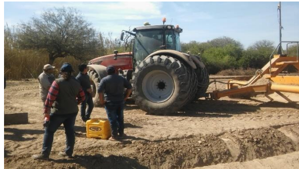
Figura 2. Pala cargadora de suelo, para volúmenes de suelo de
